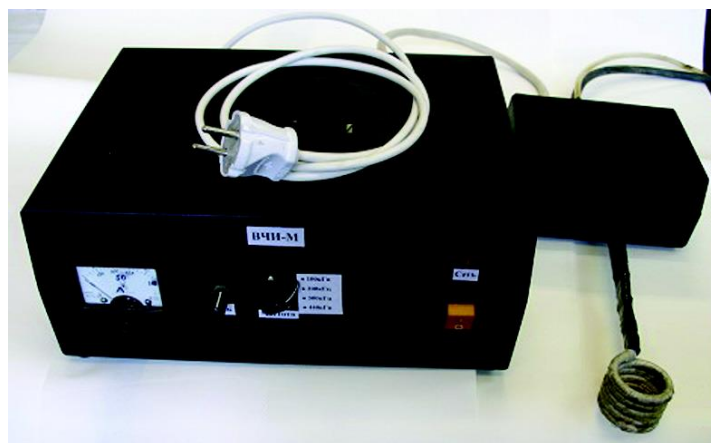
Рисунок 2.3 – Зовнішній вигляд приладу для вимірювання залежності температури магнітної рідини від часу.
